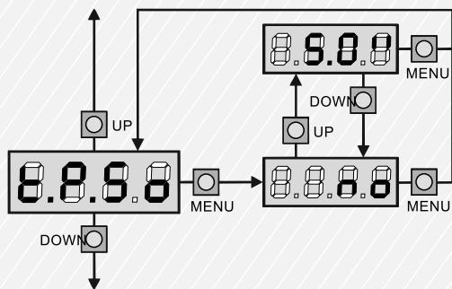
درب های در هنگام بسته شدن با یک سرعت مطلوبی حرکت می کنند. اگر با همان سرعت درب ها بسته شوند صدای بخورده بین آنها اتفاق می افتد. برای برطرف کردن این مشکل می باشیست حرکت کندشونده در هنگام بسته شدن را تنظیم نماییم تا درب های در چند ثانیه آخر به آرامی بسته شوند. در حالت مطلوب آنرا روی ۴ ثانیه قرار دهید.
