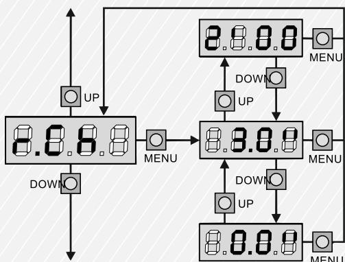
تاخیر زمانی در هنگام بسته شدن باعث میشود که درب ها در هنگام بسته شدن در بین راه به همدمیگر برخورد نکنند و این عملکرد سبب ضربه نخوردن دولنگه خواهد شد.
